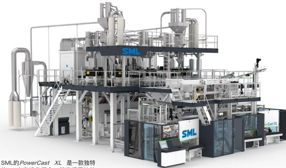
SML的**PowerCast XL** 是一款独特的4.5米宽设备概念，其高质量拉伸缠绕膜净产量高达3,400 kg/h，占地面积仅240 m<sup>2</sup>。但创新从未止步不前：新开发的一种收卷系统允许在**PowerCast XL**生产线上生产净宽4.5米的2英寸手工膜卷。
